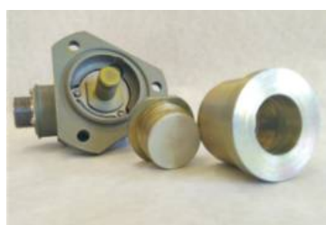
Датчик ДУП 360-1 с элементами магнитной системы и оси подвески машин
