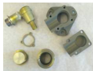
Элементы датчика ДУП 360-1 и корпуса
