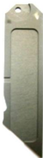
- анодное покрытие толщиной 50 мкм без окрашивания
